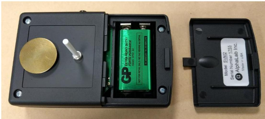
主機裝電池，貼上<磁性距針>(1吋距離磁頭隔離針)
